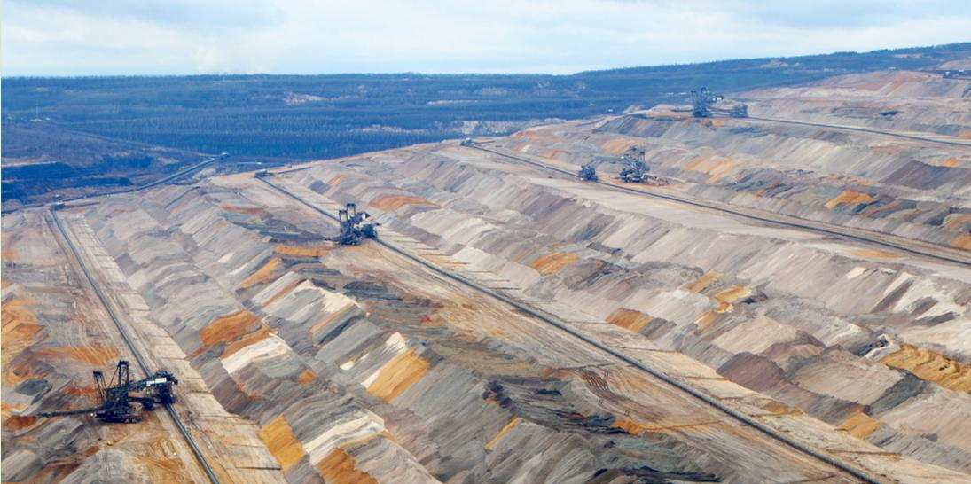
Auf der anderen Seite sind ebenfalls sehr große Maschinen im Einsatz, um den Abraum abzusetzen. Daher heißen diese Maschinen Absetzer.
