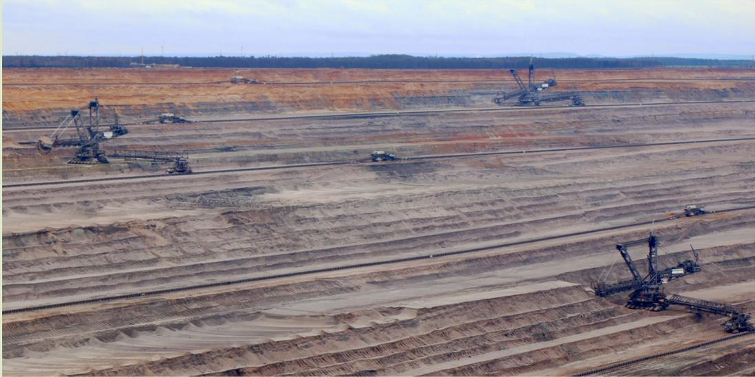
So sieht die Seite aus, auf der Kohle gefördert wird. So ein Schaufelradbagger ist mehr als 200 m lang und kann je nach Modell 110.000 bis 240.000 m<sup>3</sup> Material pro Tag fördern.
