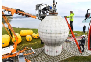
Abbildung 52: Modellversuch am Bodensee mit einer Betonkugel als Pumpspeicherkonzept (Quelle: Pumpspeicherkonzept StEnSEA, Fraunhofer Institut IWES (Kassel))
